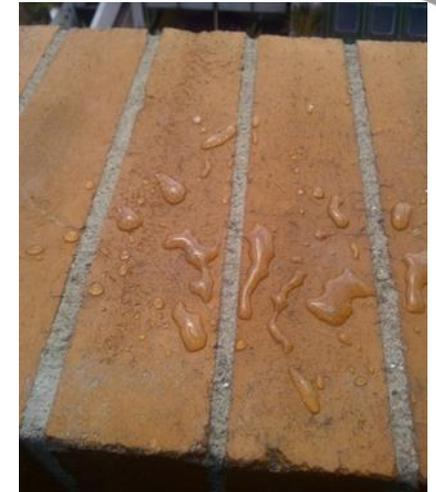
Prueba de perleado (hidrófugo)
